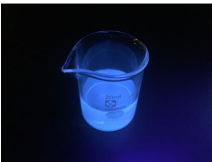
紫外線照射下でのシリコン量子ドットの発光
